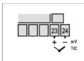
Figura 3 - conexão de Termopar e 0-50mV
